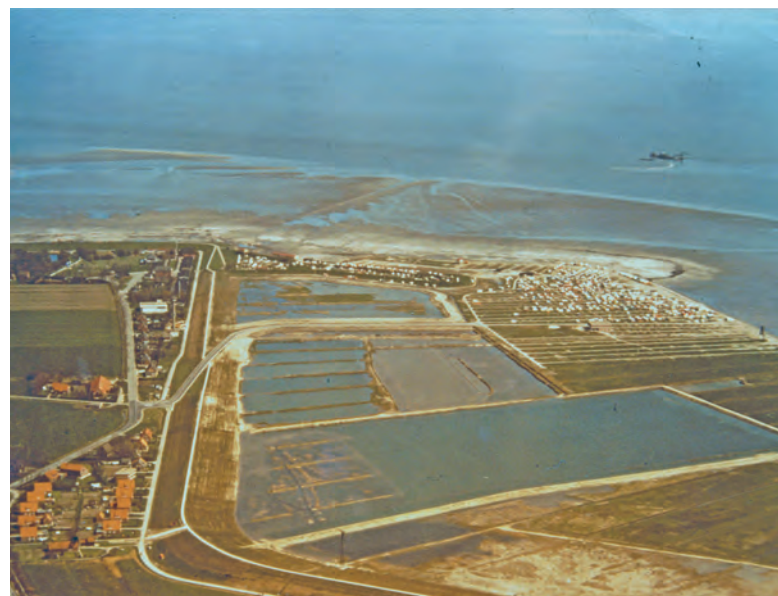
Abb. 3: Blick auf die Deichecke bei Schillighörn (oben). Rechts oben ist der Bagger der Bremer Firma Delta zu sehen, der das in die Klappstelle eingebrachte Spülgut aufnahm und durch eine Rohrleitung an den Strand pumpte. Ins Auge fallen die großen Pütten. Auf der aufgespülten Fläche der oberen Pütte befindet sich heute der große Strandparkplatz. Luftbild vom 20.04.1975; Quelle: Archiv WSA WHV.
